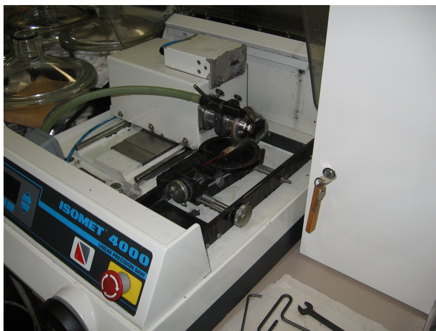
Figura 13 – Serra de discos diamantados utilizada no corte do monomorfo
